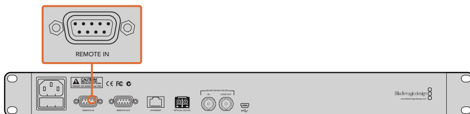
外部RS-422コントローラーをBlackmagic Duplicator 4Kの「REMOTE IN」に接続して、ユニットをリモートコントロールできます。
