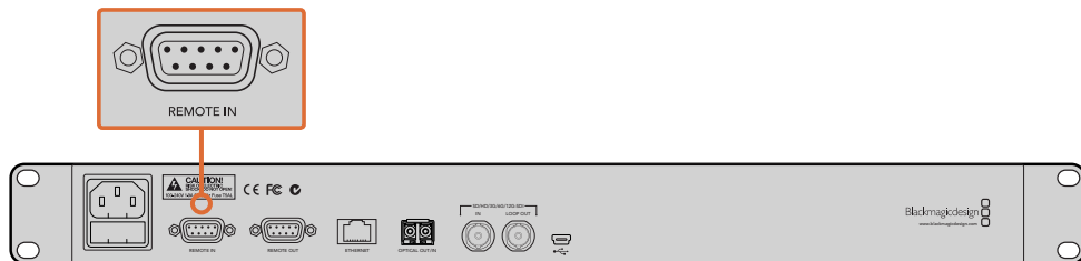
외부 RS-422 컨트롤러를 Blackmagic Duplicator 4K 리모트 입력에 연결하여 기기를 원격으로 제어합니다.
